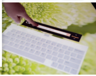
▲ Stół interaktywny, z którego korzystają studenci Wydziału Informatyki PB, odczytuje ruchy dłoni oraz rozpoznaje do 50 różnych obiektów położonych na ekranie. Fot. PB
