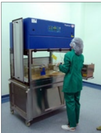
Stacja wymiany klatek.
