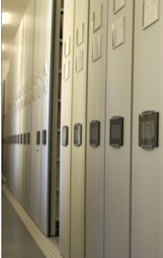
Regały kompaktowe z napędem elektrycznym, w magazynie bibliotecznym
