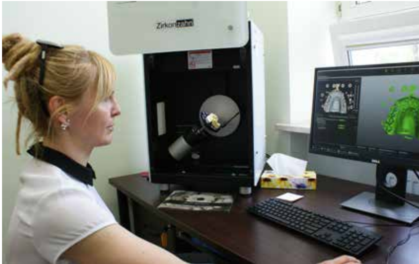
Najpierw skanuje się wycisk szczęki (maszyna po lewej), a później obrabia model na komputerze
