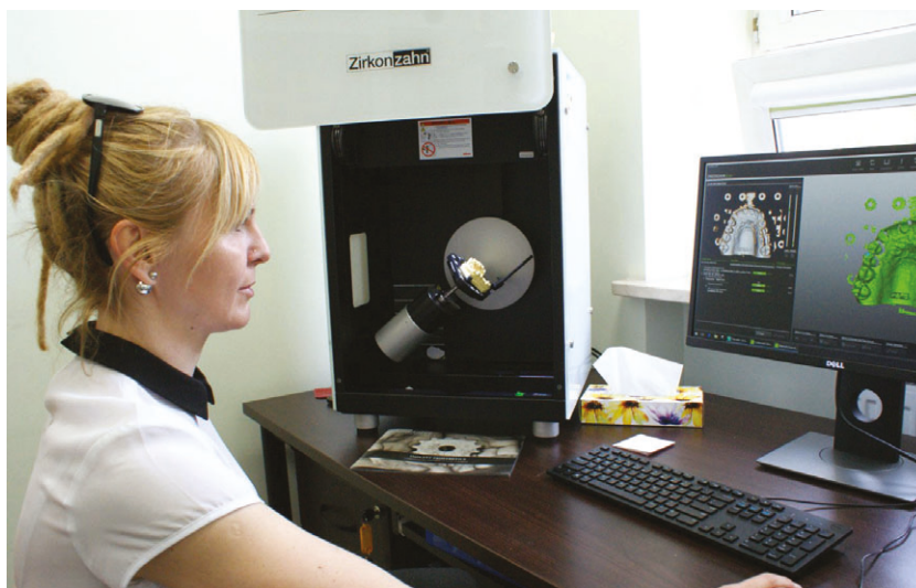
Cyfrowe projektowanie koron zębowych przy użyciu programów CAD/CAM
