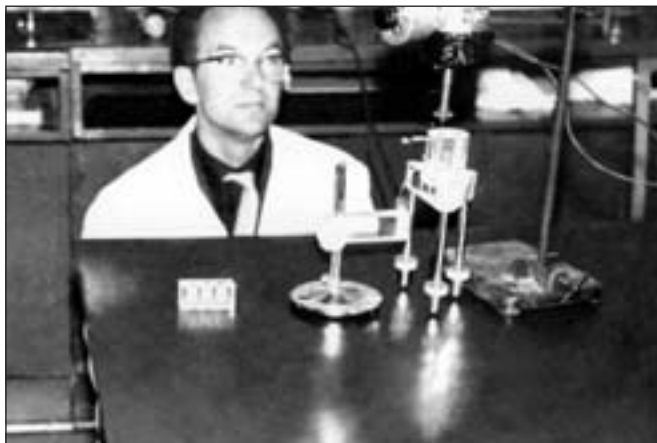
Fot. Aparat do sporządzania roztworów gradientowych, sporządzony przez prof. Gałasińskiego.
