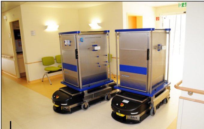
Automatyczne roboty transportowe wykorzystywane w szpitalu w Greifswaldzie
