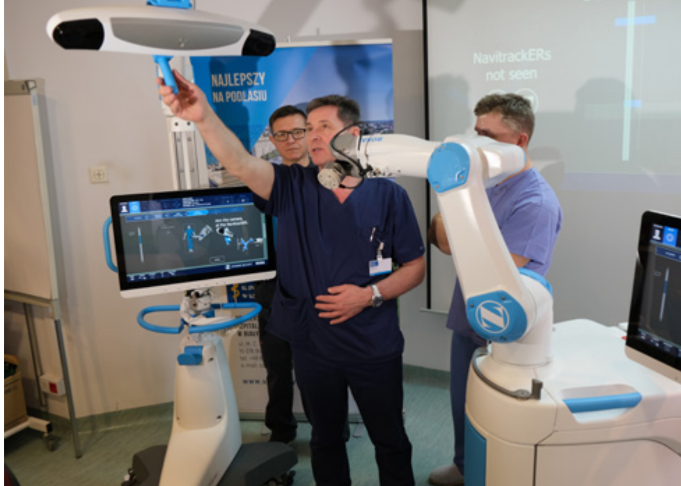
Robot ortopedyczny składa się z dwóch urządzeń: kamery z czujnikami (na zdjęciu ustawia je dr Jan Kiryluk) oraz modułu z ramieniem robotycznym, fot. Wojciech Więcko
