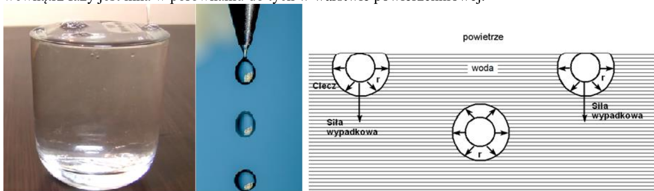
Ryc. 2. Oddziaływania pomiędzy cząsteczkami cieczy zapewniają jej dużą spójność, tak że możliwe jest napełnienie naczynia powyżej krawędzi, a płaskie przedmioty mogą swobodnie utrzymywać się na powierzchni. Schemat z prawej strony przedstawia rozkład sił pomiędzy cząsteczkami cieczy. Pod powierzchnią cieczy siły wzajemnego oddziaływania kompensują - każda cząsteczka posiada wokół siebie inne cząsteczki oddziaływujące na siebie nawzajem. W warstwie powierzchniowej cząsteczki przyciągane są wyłącznie ze strony cieczy - są wciągane w głąb cieczy dążąc do zmniejszenia swobodnej powierzchni cieczy. Istnienie tych sił powoduje, że
